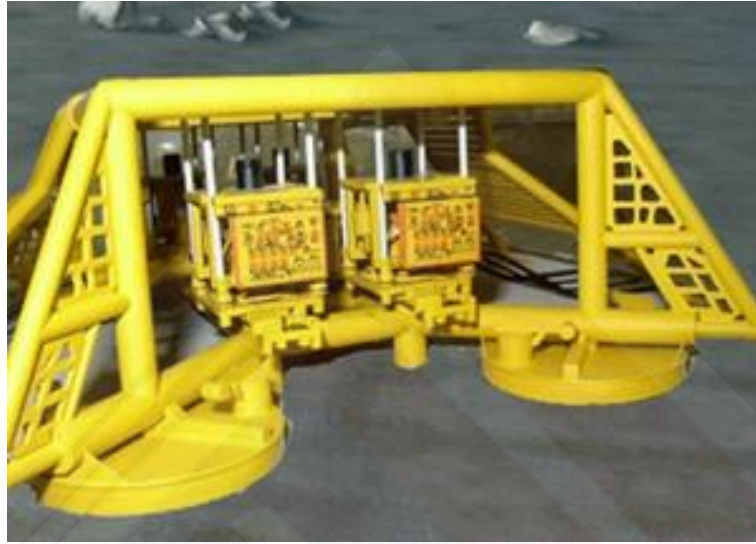
الشكل (4-18) هيكل "قالب" بداخله عدة أشجار ميلاد
